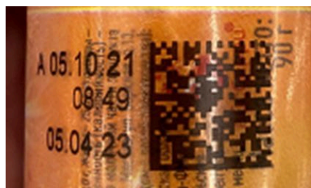
Печать кода маркировки на бликующей/светоотражающей поверхности
