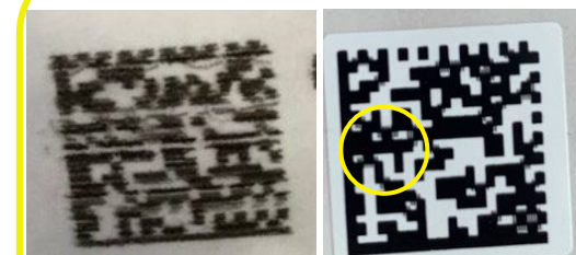
Смазывание кода маркировки или его отдельных элементов
