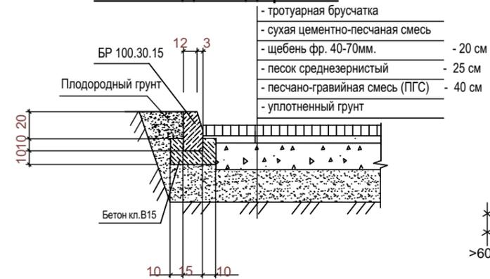
**Узел примыкания тротуаров к проездам**
