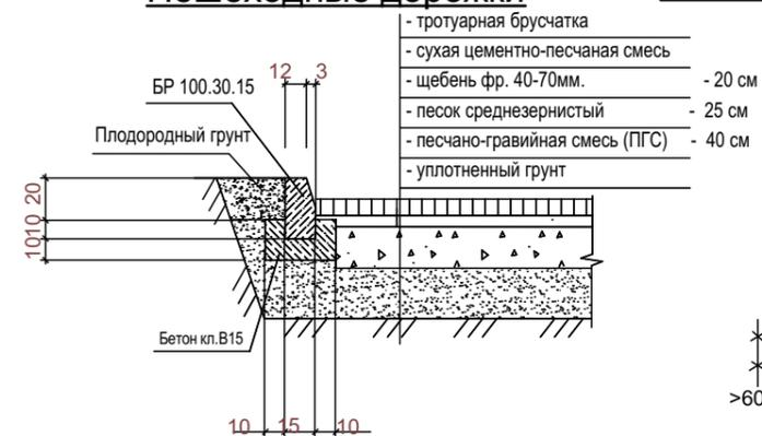
Узел примыкания тротуаров к проездам
