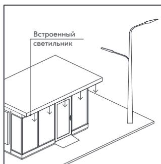
НТО должны быть оснащены навесом для защиты пользователей от неблагоприятных погодных условий и освещением в темное время суток с помощью встроенных либо отдельно стоящих светильников.
