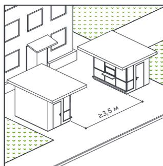
Ширина свободных пешеходных зон между отдельно стоящими НТО для проезда пожарной и обслуживающей техники составляет  $\geq 3,5$  м.
